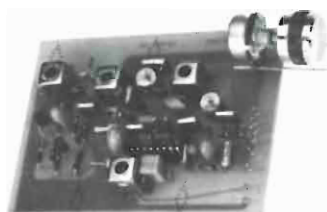
Prototipo di laboratorio di ricevitore AM realizzato con l'integrato TDA 1072. La sintonia è a diodi varicap
