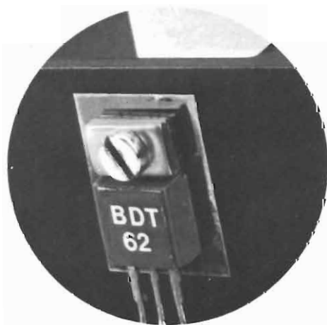
Prototipo di laboratorio dell'amplificatore Hi-Fi di potenza da 25/30 W realizzato con i Darlingtong BDT 62/63 in contenitore TO-220
